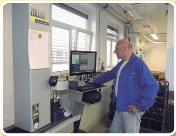
La solución de ZOLLER para GMN Paul Müller Industrie GmbH & Co. KG: dispositivo de ajuste con TMS Tool Management Solutions.
